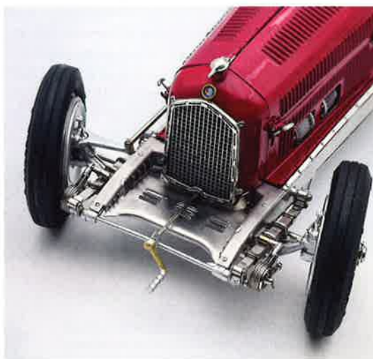
Die Vorderachsaufhängung mit Blattfedern und Trommelbremsen besteht aus vielen einzelnen Metallteilen.
