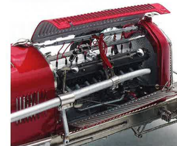
Eingebauter Reihen-Achtzylinder in zwei Blöcken, elektrisch bereits voll verkabelt.
