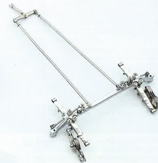
Blattfedereinheit, von Hand eingespeichte Räder, Achtzylinder-Reihenmotor in zwei Blöcken und die Bremsanlage mit Gestänge – in jedem dieser Bauteile stecken viele Einzelteile, allein am Motorblock sind es 85 Edelstahlschrauben.
