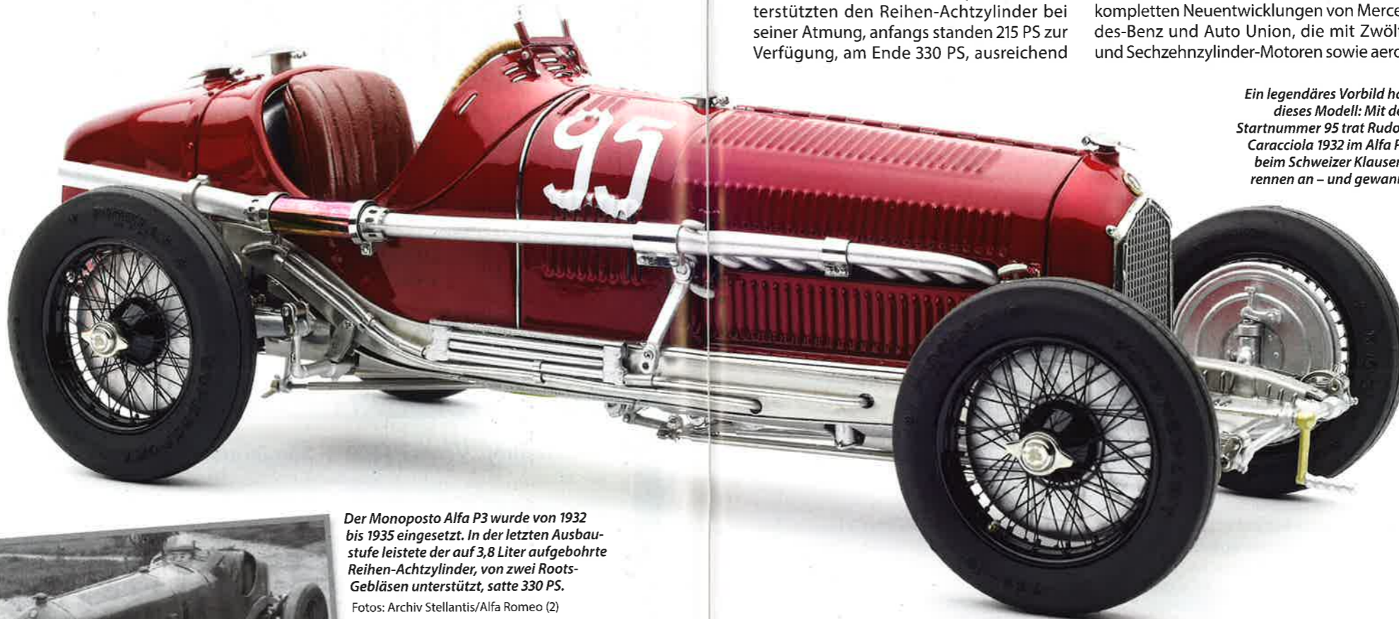
Die Vorderachsaufhängung mit Blattfedern und Trommelbremsen besteht aus vielen einzelnen Metallteilen.
