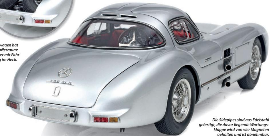
Die Sidepipes sind aus Edelstahl gefertigt, die davor liegende Wartungsklappe wird von vier Magneten gehalten und ist abnehmbar.
