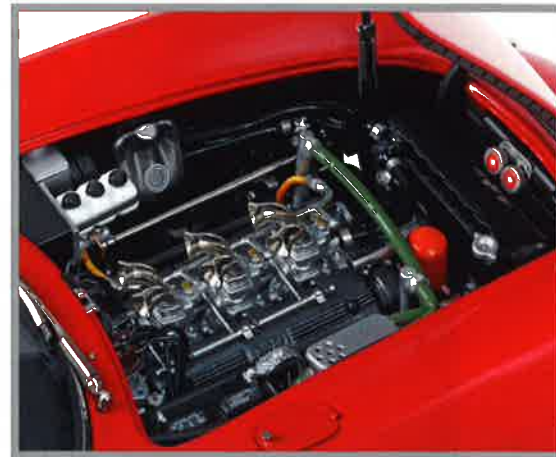
Bei der Nachbildung der Luftansaugtrompeten experimentierte CMC. Welches Material in welchem Durchmesser ließ sich so in Form bringen? Auch in einem Modell-Zwölfzylinder kann viel Entwicklungsaufwand stecken.
