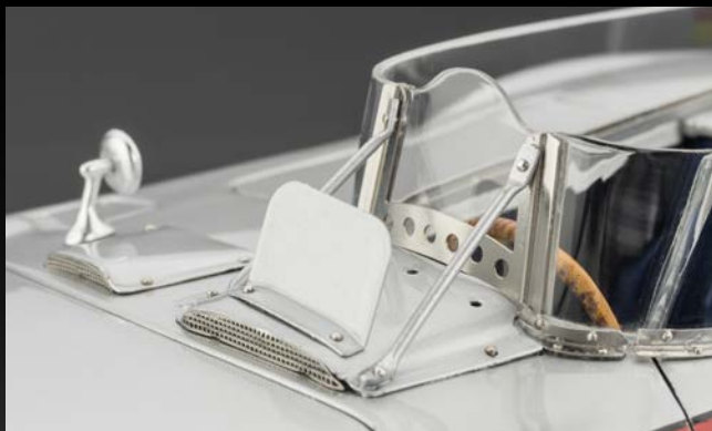
Bei den Single-Fahrern Fangio und Kling war die Beifahrerseite mit einer Metallplatte abgedeckt. Kling war mit einem zusätzlichen Steinschlagschutzschild vor der Windschutzscheibe unterwegs.
