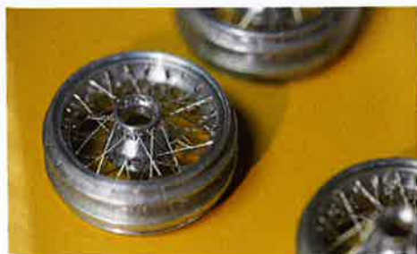
Bei CMC-Modellen kann alles demontiert werden – eine Pinzette liegt jedem Exemplar bei. Felgen werden von Hand eingespeicht, Lenkräder mit echtem Leder bezogen
