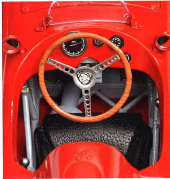
Een blik in de Lancia-cockpit. Door het stuur kijkend zie je links de cardanas schuin naar achter lopen.
