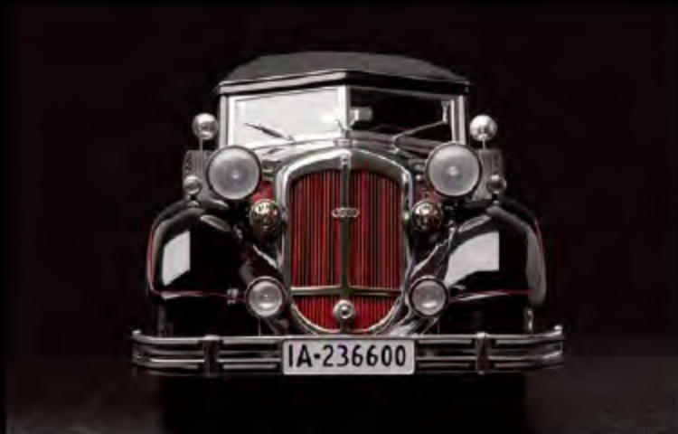
Kühlermaske mit handeingezogenen Vertikalstäben, komplett aus Edelstahl gefertigt.
