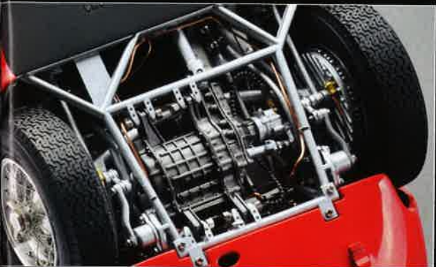
Technische Sahnestückchen inszeniert CMC mit dem bärenstarken Motor und der aufwendigen DeDion-Hinterachse in 1:18
