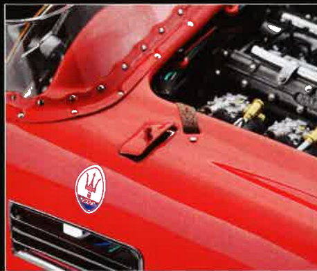
Der Drehzahlmesser steht kopf (ganz oben), die Klappe belüftet die Füße (oben links), winzige Gurte halten die Hauben des 300 S
