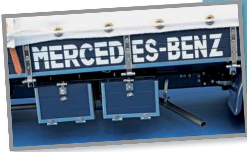
Die mittig befestigten Auffahrrampen lassen sich lösen und am Heck einhängen
