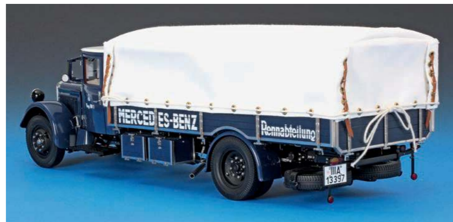
Die Stoffplane wird von Ösen, feinen Lederriemen und einer gut zu handhabenden Schnur gesichert. Man will die Plane ja auch mal abnehmen
