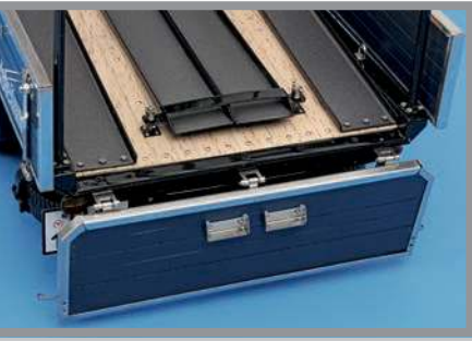
Die mittig befestigten Auffahrrampen lassen sich lösen und am Heck einhängen
