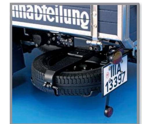
Zwei Ersatzreifen trägt der Lkw im Heck, die sich natürlich herausnehmen lassen. Das filigrane Fahrgestell ist Techniklehrstunde pur
