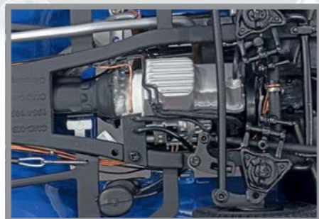
Von unten betrachtet, fallen Getriebe, Nebenaggregate sowie die Vorderachse ins Auge
