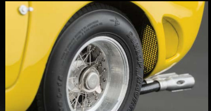
Hinteres Radhaus mit Entlüftungsöffnung zur Wärmeabfuhr der Bremse. Vorbildgetreue Alu-Tiefbettfelge.
