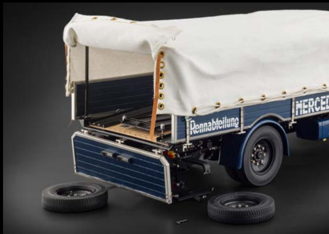
Zu öffnende Ladebordwände und eine abnehmbare Verdeck Plane, gesichert mit feinen Lederriemen. Haltebügel der Reserveräder können abgeklappt und die Räder entnommen werden.
