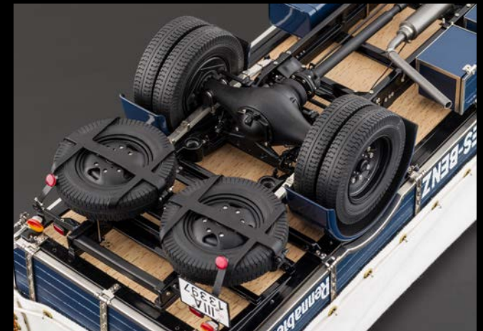
Feinste Details auch am Fahrgestell mit funktionsfähiger Blattfeder-Aufhängung und Bremsleitungen.
