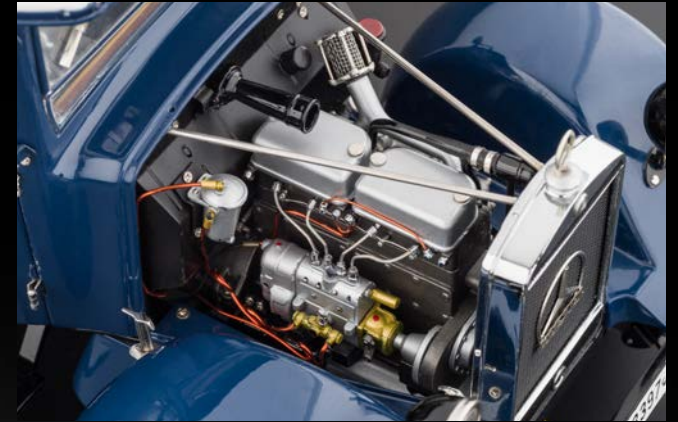
Wunderschön umgesetzter 4-Zylinder Dieselmotor mit allen Anbauaggregaten und kompletter Leitungsverlegung.
