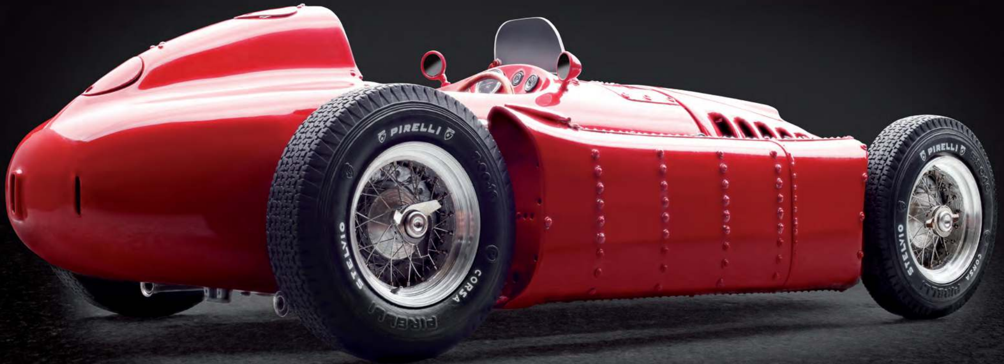
Ästhetisch und aerodynamisch höchst innovativer Formel 1-Rennbolide. Sein Konstrukteur, Vittorio Jano platzierte zwischen den frei stehenden Rädern entlang der linken und rechten Karosserieaußenseite lange, schmale Kraftstofftanks. Ein Novum in der damaligen Rennszene.
