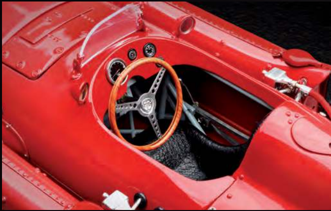
Spartanisch ausgestattetes Cockpit mit seitlich angeordneten Ölkühlern für die Motor-Trockensumpfschmierung.
