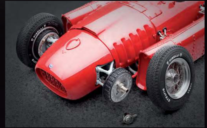
Moderne Dreieckslenker-Vorderradaufhängung mit fein gerippter Bremstrommel. Am Modell lassen sich die Räder abnehmen.
