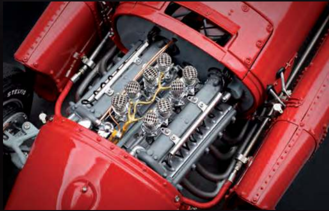
Der schräg eingebaute Frontmotor wird flankiert von den beiden außenliegenden Kraftstofftanks.
