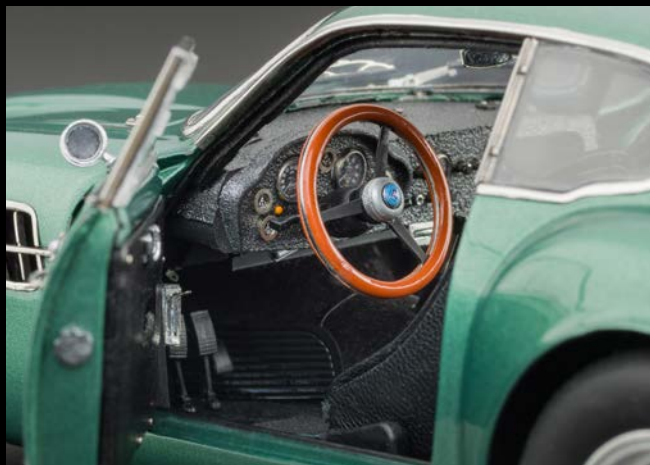
Aufwendig gestaltetes Armaturenbrett mit auffälligem Schruppflack-Überzug.
