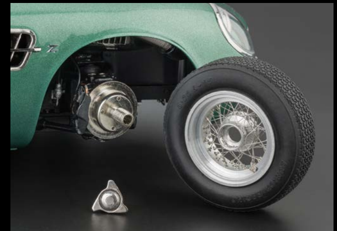
Abnehmbare Räder mit Zentralverschluß in Rechts- / Linksgewinde Ausführung. Imposante Reifen, aufgezogen auf Leichtmetall-Speichenfelgen verdeutlichen den Rennsportcharakter.
