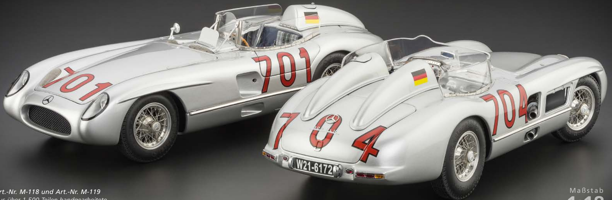
Bei den Single-Fahrern Fangio und Kling war die Beifahrerseite mit einer Metallplatte abgedeckt. Kling war mit einem zusätzlichen Steinschlagschutzschild vor der Windschutzscheibe unterwegs.
