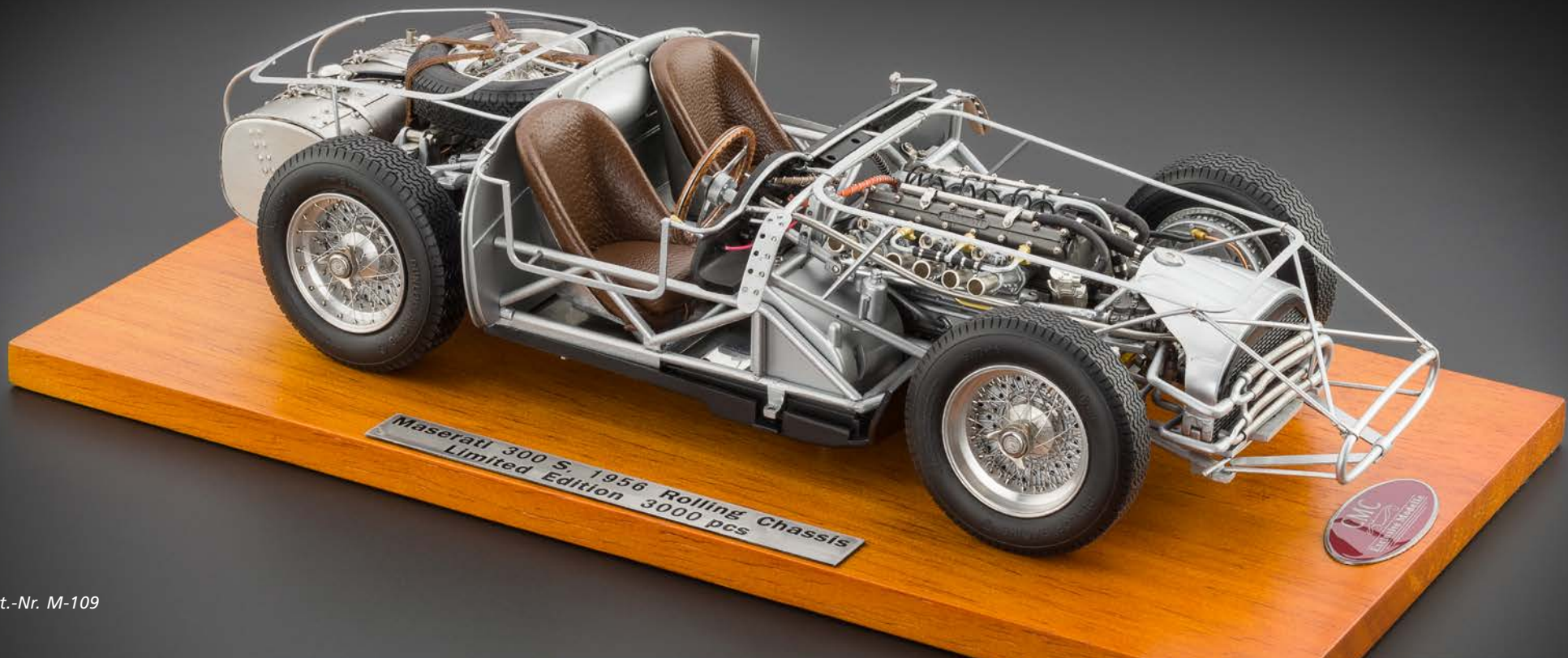
Das Reserverad ist im Heckteil mit drei Lederriemen fixiert. Benzin- und Öltank sind aus Edelstahlblech-Teilen zusammengefügt.
