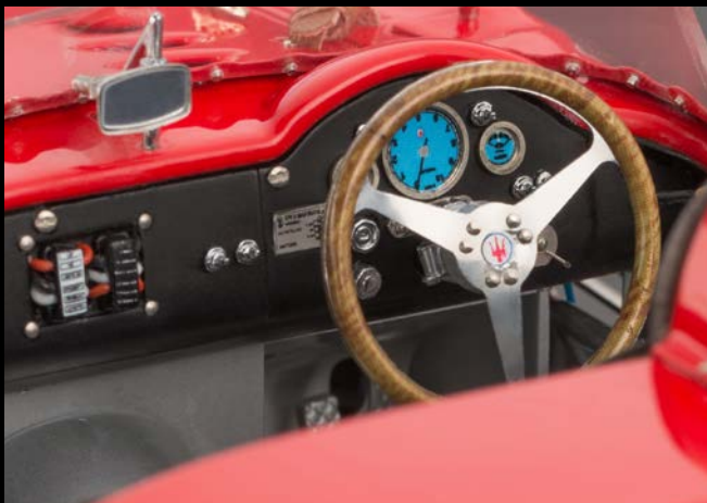
Die Rundinstrumente des Armaturenbretts sind präzise nachempfunden. Der „Kopfstand“ der Drehzahlmesserskala ist gewollt.
