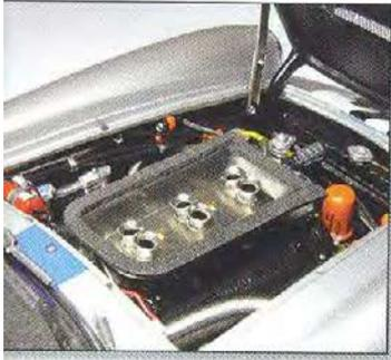
La placa metálica que cubre el motor ayudaba a la admisión de aire de los tres carburadores. El maletero queda completamente ocupado por la rueda de repuesto y el depósito de gasolina.
