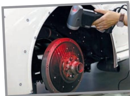
Neukonstruktionen werden mit Lasertechnik vermessen und die gewonnenen Daten mit CAD-Programmen weiterverarbeitet. So akribisch wird nicht nur die Karosserie erfasst, sondern auch die Details drinnen und darunter. Denn CMC hat den Anspruch, dass die Modelle so getreu wie möglich dem Original nachempfunden sind. Und in 1:18 ist das möglich.
