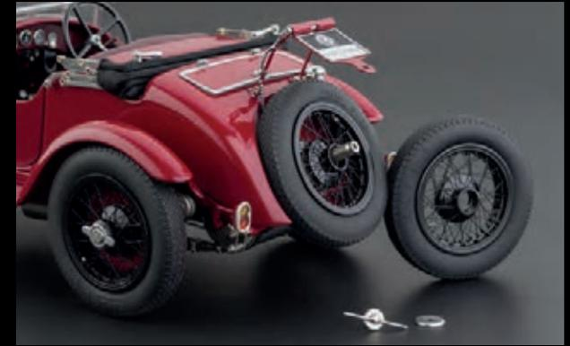
*Nach Lösen einer Knebelschraube sind die beiden Reserveräder abnehmbar*
