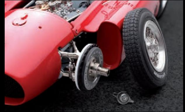
*Bei abgezogenem Rad wird die Aufhängung an Dreieckslenkern sichtbar*
