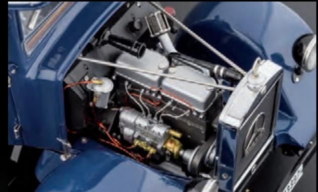
*Perfekt umgesetzter 4-Zylinder-Dieselmotor mit allen Anbauaggregaten und kompletter Leitungsverlegung*
