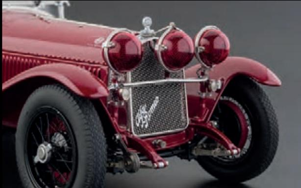
Die transparenten roten Scheinwerferabdeckungen sind abnehmbar - im Original dienten sie der Fahrzeugaerodynamik
