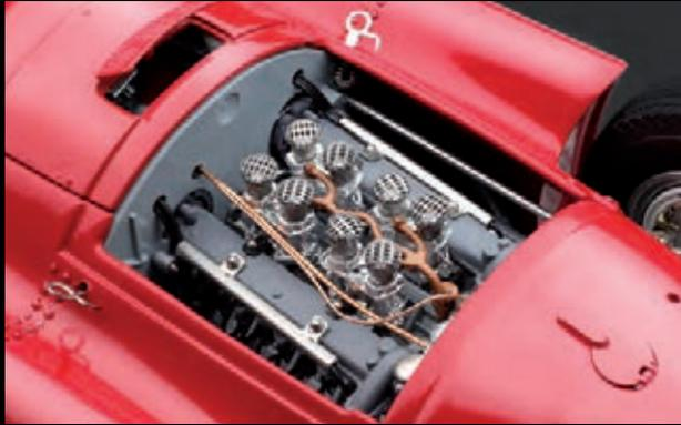
*Der V8-Motor mit Zylinderwinkel von 90 Grad ist detailliert wiedergegeben*
