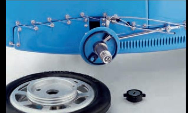
*Radkonstruktion aus 35 Teilen mit Rädern in Aluguss-Design und angeflanschten Bremstrommeln*
