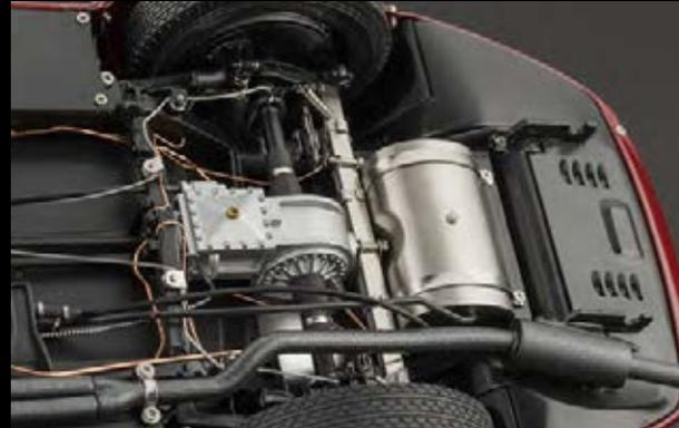
Das Transaxle-Getriebe ist mit dem Hinterachsdifferential verblockt
