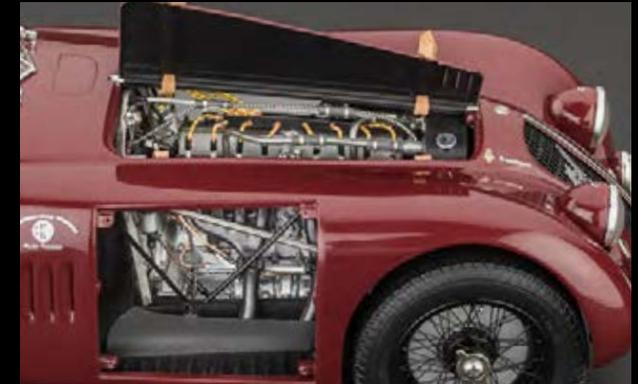
Hochdetaillierter 8-Zylinder-Reihenmotor, Kurbelgehäuse aus Leichtmetall-Blöcken mit je vier Zylindern
