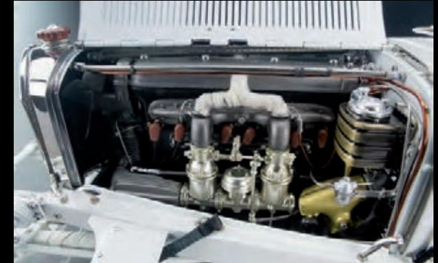
*Mit dem größeren der beiden Wettbewerbskompressoren, hausintern "Elefant" genannt, wurden auf dem Prüfstand 310 PS gemessen*
