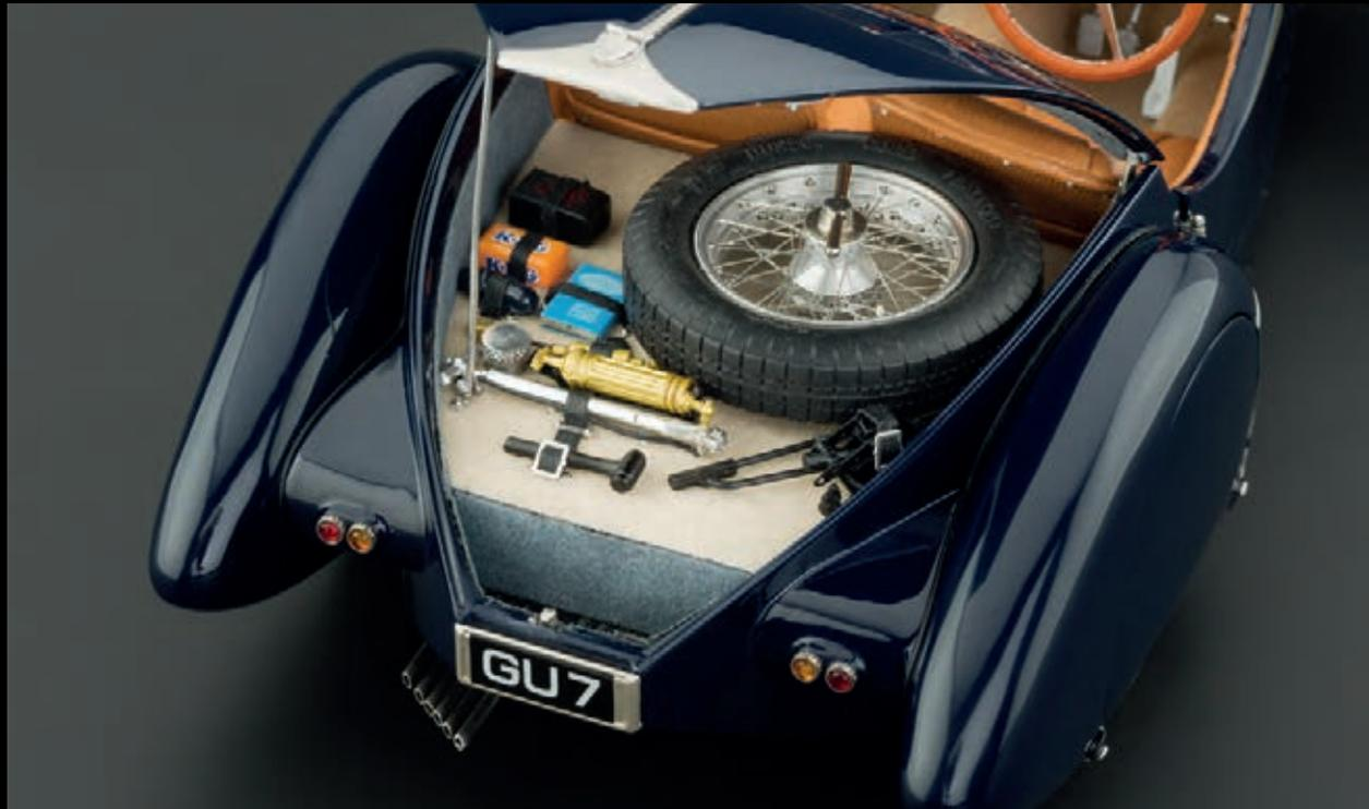
*Im Kofferraum sind Wagenheber, Luftpumpe, Fettpresse, Teileboxen und Werkzeugsatz nachmodelliert*
