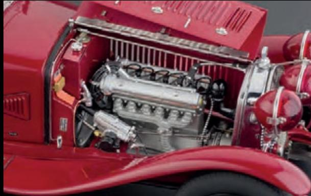
Hochdetaillierter Sechszylindermotor mit stirnseitig montiertem Roots-Kompressor, allen Anbauaggregaten und kompletter Leitungsverlegung / -verkabelung
