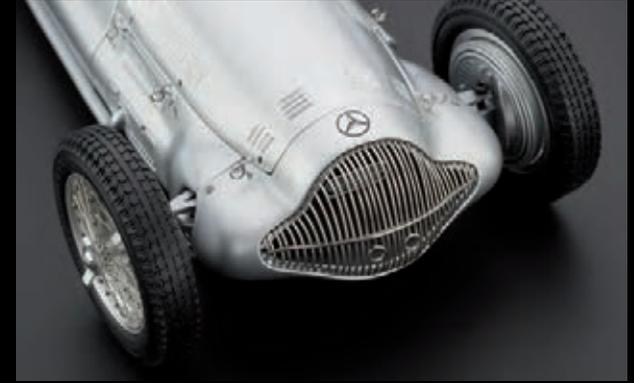
Der Kühlergrill besteht aus feinen, handgezogenen Drähten, die einzeln eingelötet werden
