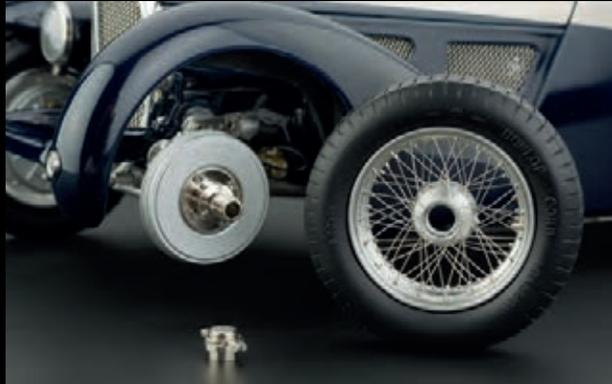
*Perfekte Speichenräder und schraubbare zweiflügelige Zentralverschlüsse mit Rechts- / Linksgewinde zum Abnehmen der Räder*
