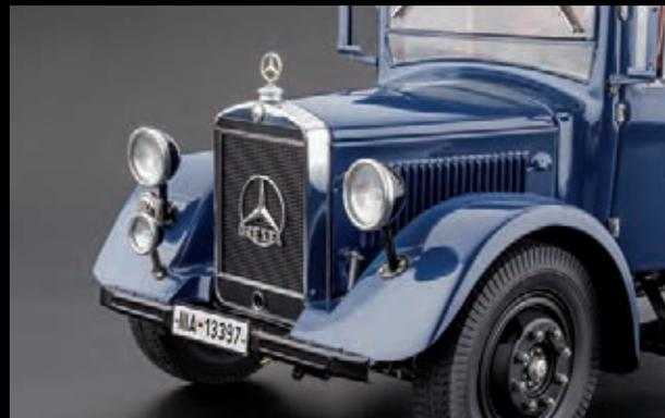
*Der Kühlerverschlussdeckel mit aufgesetztem Mercedes-Stern lässt sich per Schraubverschluss öffnen*
