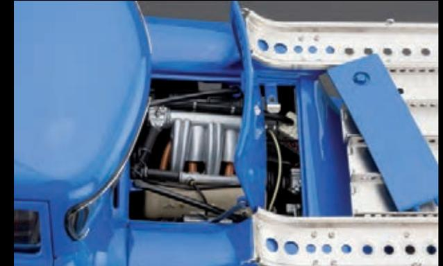
Aufklappbare Motorabdeckung und abnehmbare Wartungsklappe
