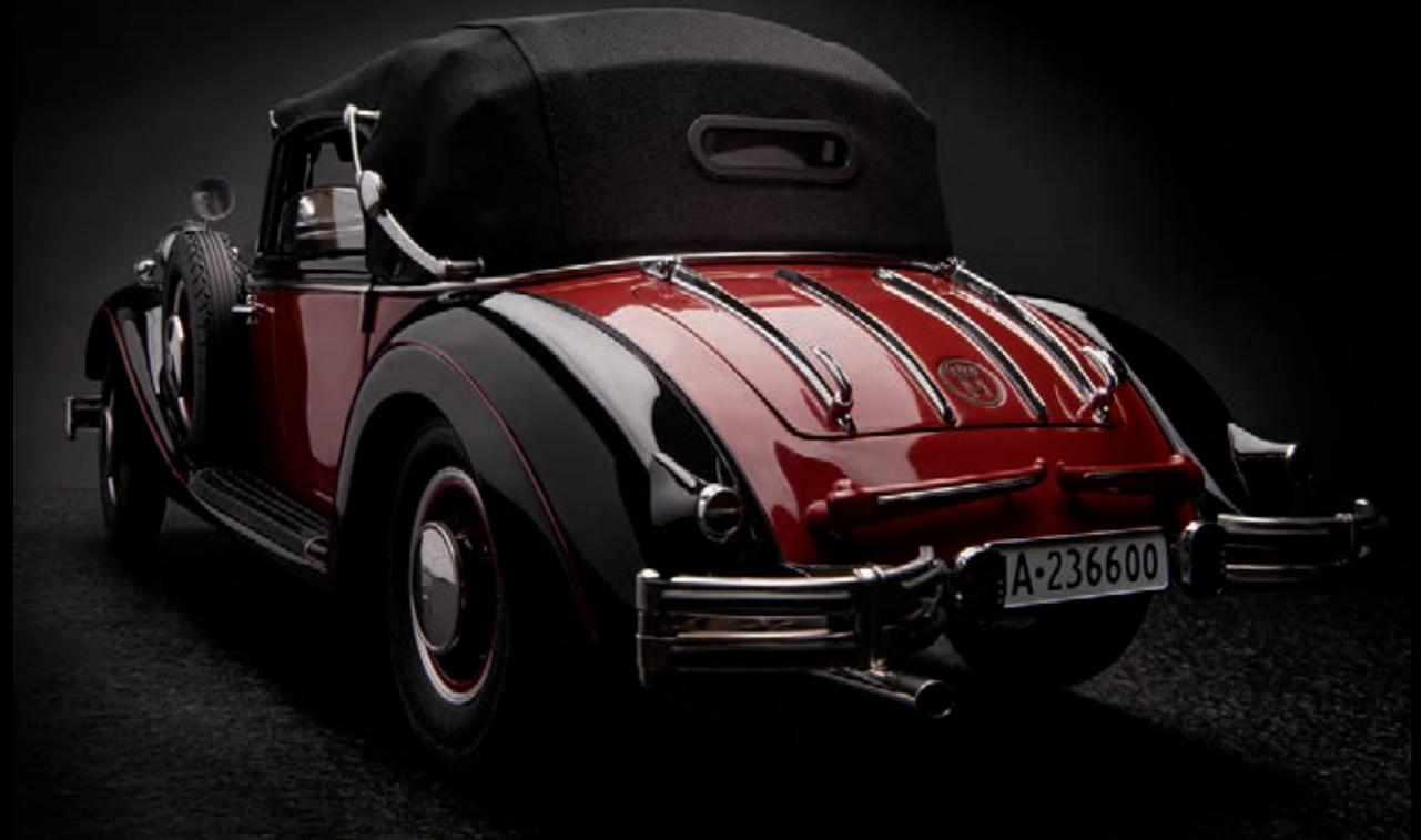
Unser ca. 2,2 kg schweres Modell wird in aufwendiger Handarbeit gefertigt. Die Karosserieteile aus 0,6 mm starkem Kupferblech werden in Formen gepresst und anschließend miteinander verlötet
