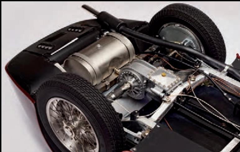
*Das Transaxle-Getriebe ist vorbildgetreu mit der Hinterachse verblockt*
