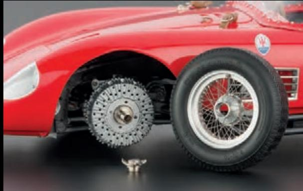
Detailliert ausgearbeitete Bremstrommeln und abnehmbare Speichenräder mit authentischer Bereifung
