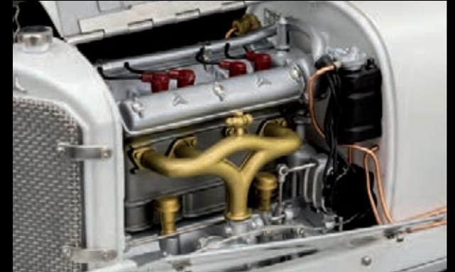
Originalgetreu dargestellter Vierzylindermotor mit allen Nebenaggregaten und Leitungen
