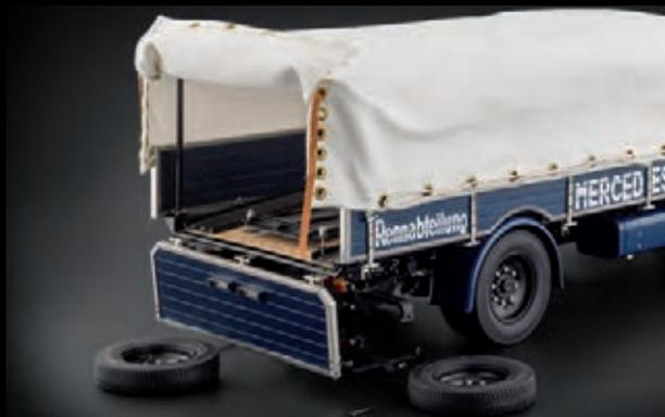
*Zu öffnende Ladebordwände und abnehmbare Verdeckplane, gesichert mit feinen Lederriemen*
