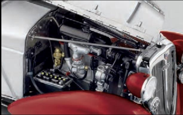
Sechszylindermotor mit allen Anbauaggregaten, kompletter Leitungsverlegung und Verkabelung
