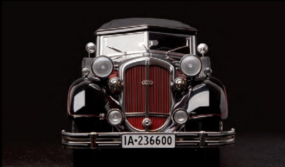
*Kühlermaske mit handeingezogenen Vertikalstäben, komplett aus Edelstahl gefertigt*
