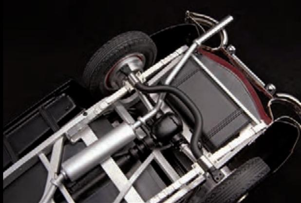
Stabiler Metall-Fahrzeugrahmen aus geformten Aluprofilen.
