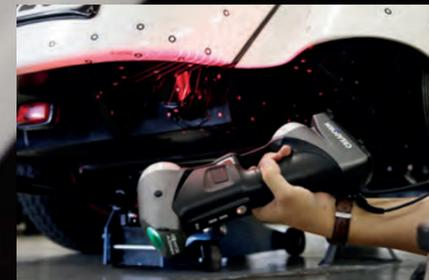
Das Originalfahrzeug wird mit einem Scanner minutios digital vermessen. Dazu tastet das CMC-Team anhand aufgeklebter Referenzpunkte die gesamte Außenhaut des Fahrzeugs systematisch in definierten Schrittfolgen ab und erhält auf diese Weise eine digitale Abbildung der Karosserie-
